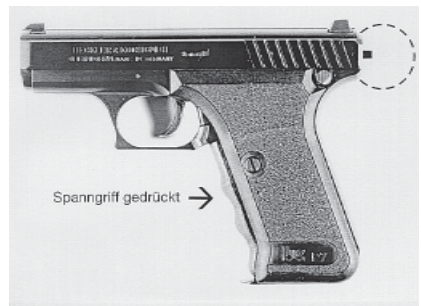
gespannt und entsichert
