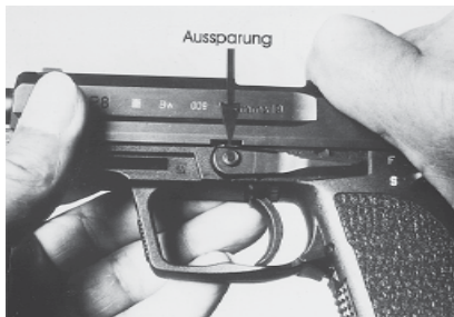
Lage Aussparung/Verschlussfanghebel Verschlussfanghebelachse Zerlegen der Pistole
