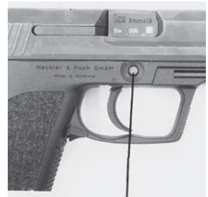
Lage Aussparung/Verschlussfanghebel Verschlussfanghebelachse Zerlegen der Pistole
