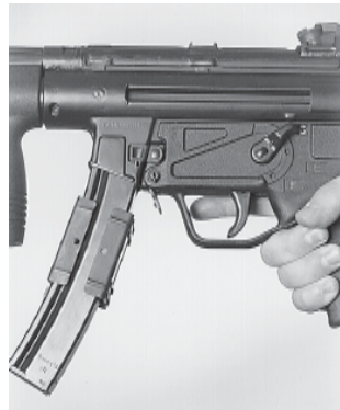
Magazin mit Magazinklammer in Magazinschacht eingeführt
